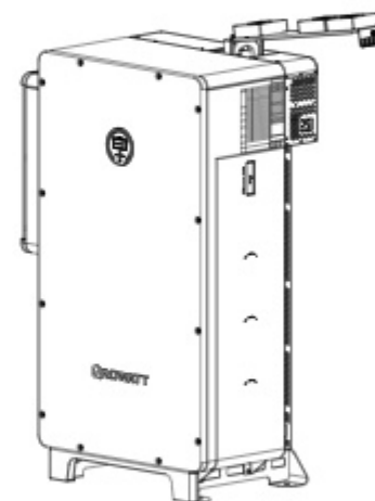
Fig 9.2 Position of the fan
