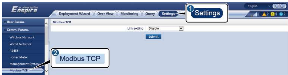
Figure 6-13 Setting Modbus TCP parameters
